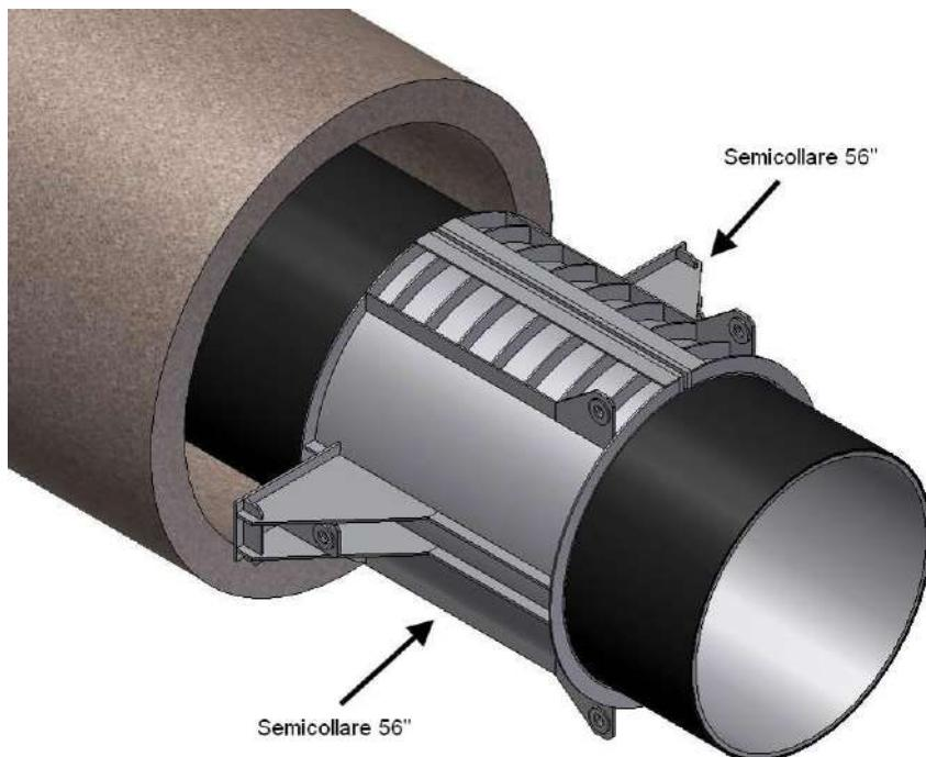
La resistenza del sistema di trattenuta dovrà essere dimensionata sulla base della geometria del tunnel.
